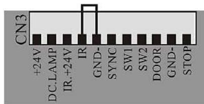
در صورت استفاده نکردن از فتوسل، کانکتور IR را توسط یک جامپر به GND متصل نمایید. (LED3 باید در وضعیت دائم روشن قرار گیرد).
