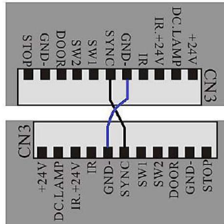
در صورت استفاده نکردن از فتوسل، در هر دو مرکز کنترل کانکتور IR را به GND متصل کنید.
