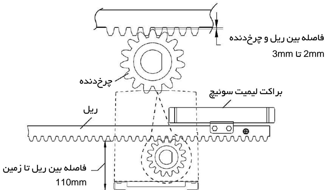
فاصله بین ریل و چرخ دنده باید دقیقاً مطابق مشخصات بالا باشد، در غیر این صورت ممکن است عملکرد موتور و عملکرد درب به صورت دستی دچار اختلال شود.
