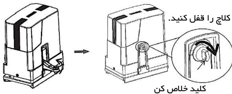
توجه: بعد از استفاده از سیستم خلاص کن درب بازکن، اطمینان حاصل کنید که دستگاه از حالت خلاص خارج شده است.
